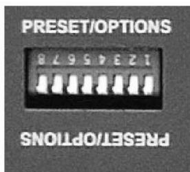
Auf der Rückseite von **pocketC** etwa in Höhe von den Reglern 6 bis 7 befinden sich im Gehäuse eine rechteckige Öffnung, die Zugriff auf einen 8 poligen sogenannter DIP- Schalter gewährt. Beschriftet ist diese Öffnung mit **PRESET/OPTIONS**. 8 polig deshalb, weil es sich streng genommen nicht nur um einen Schalter handelt, sondern um derer gleich 8, allerdings 8 sehr kleine Exemplare, die jeweils 2 Stellungen einnehmen können.
